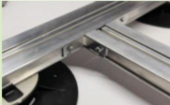
Mit Hilfe des TZ Winkelset können mögliche Querverbinder sehr leicht montiert werden. Die Winkel bestehen aus 3 mm Material und sind bereits gelocht, so dass die Verschraubung mit den selbstschneidenden Bohrschrauben (Sechskant 4,8 x 19 galv. verzinkt) leicht erfolgen kann.
