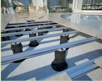
Bei der Verlegung von 2 cm Keramikplatten in Mischverbänden bzw. bei speziellen Formaten kann eine Unterkonstruktion aus Aluminiumprofilen sehr sinnvoll sein. Die Stelzlager der Serie SSE haben spezielle Köpfe für die Aufnahme der Profile, die für ein hervorragendes Ergebnis in Bezug auf Sicherheit, Schnelligkeit bei der Verlegung und Stabilität der Lauffläche sorgen.
